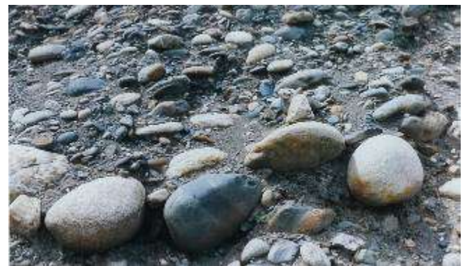
Figure 4. Alluvions récentes dans la gravière en exploitation à Bas Mour ( La Barthe , altitude 520m). Observer l'imbrication, ou assiette , des galets.
